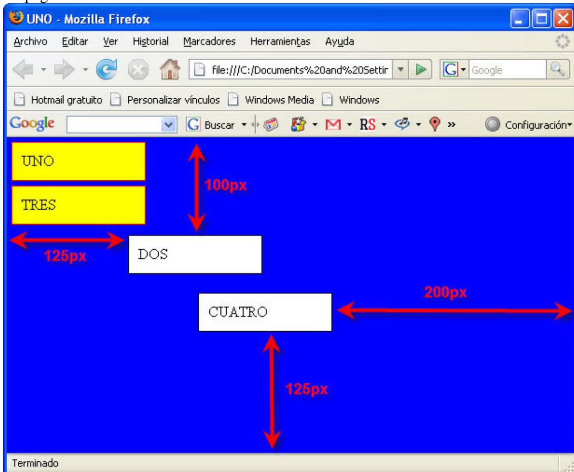
Es fácil ver que se han colocado las cajas 1 y 3 manera estática, como si no existiesen más elementos y la 2 y 4 se han colocado con un posicionamiento absoluto.
