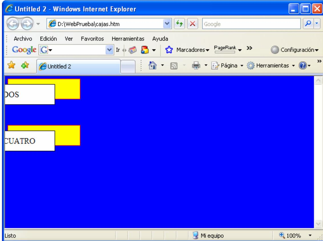
En el videotutorial [Posicionamiento relativo](#) de 4m 45seg. de duración se explica la distribución relativa, que es igual que el `flow layout` o distribución en flujo pero en el que un elemento, después de ubicarse en la posición de flujo que le corresponde, se desplaza relativamente lo que indiquen sus propiedades `top`, `left`, `right` y `bottom`.
