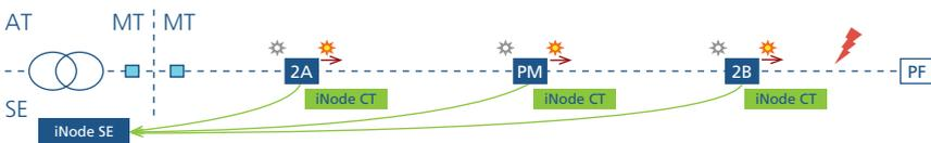
Fig. 51. Falta en línea de MT, entre el CT 2B y PF. Escenario con comunicación entre CTs e *iNodes*
