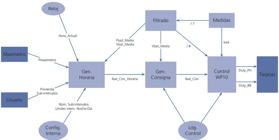
Fig. 80. Estructura de control implementada
