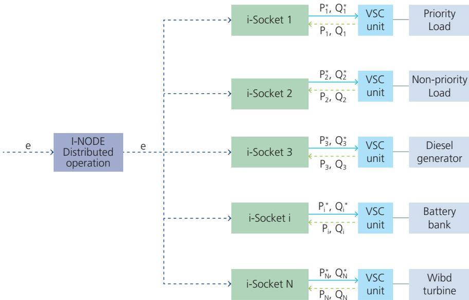
**Fig. 73.** Esquema de control en modo distribuido
