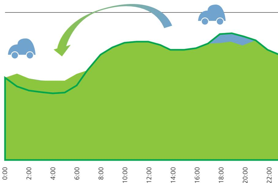
**Fig. 37.** Aplanamiento de la curva de demanda mediante vehículos eléctricos y puntos de recarga V2G (Fuente: Red Eléctrica de España)
