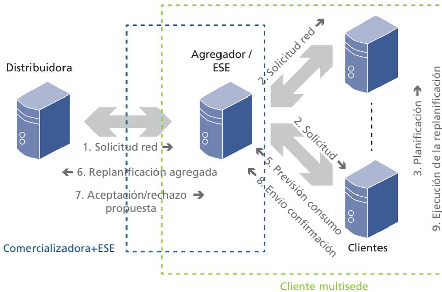
Fig. 40. Esquema SGAD Potencia
