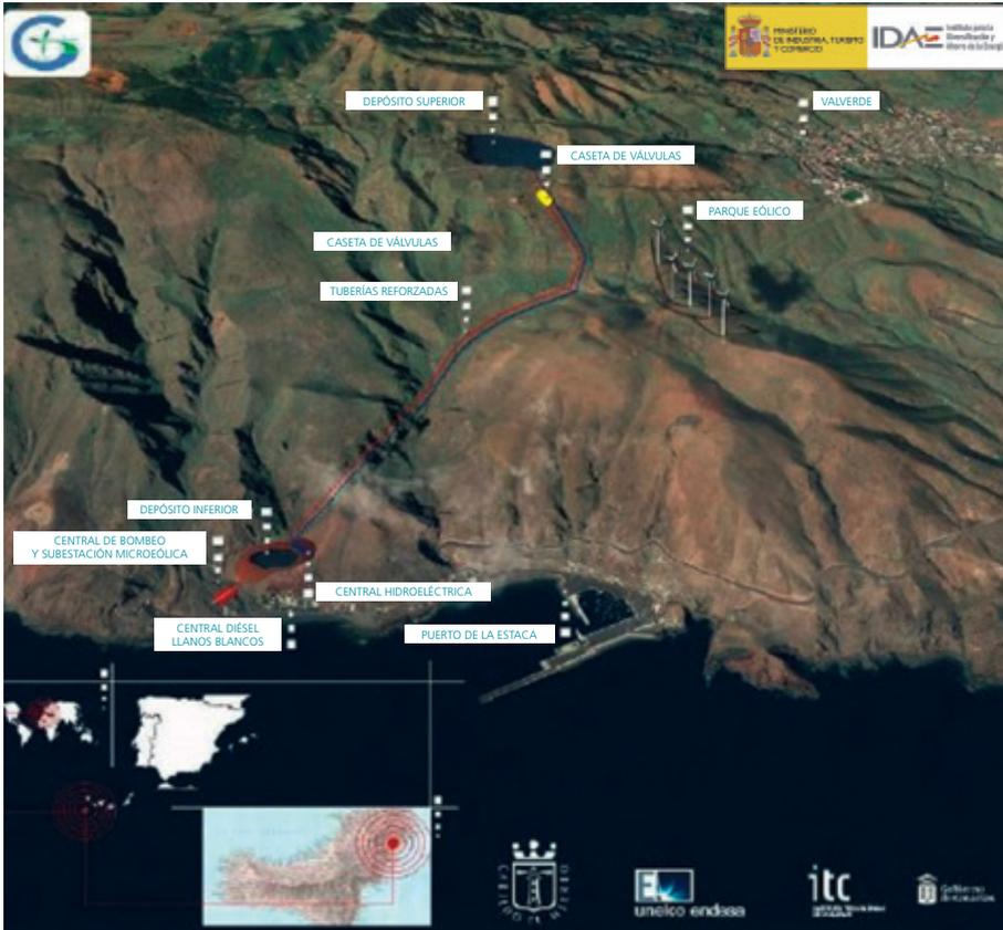
Fig. 100. Esquema de la central de generación hidroéolica de El Hierro
