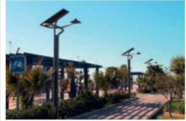
Fig. 30. Farolas con paneles solares fotovoltaicos incorporados (p. 53)
