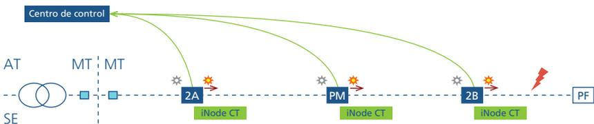
Fig. 52. Falta en línea de MT, entre el CT 2B y PF. Escenario con comunicación entre CTs y centro de control
