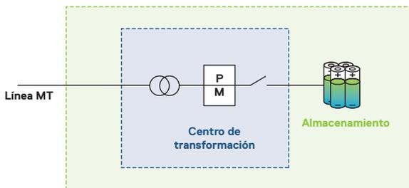
Fig. 24. CT con almacenamiento conectado a un nodo de MT de la red de distribución
