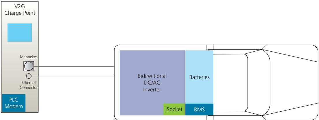
Fig. 88. Esquema de conexión del cargador con el punto de recarga
