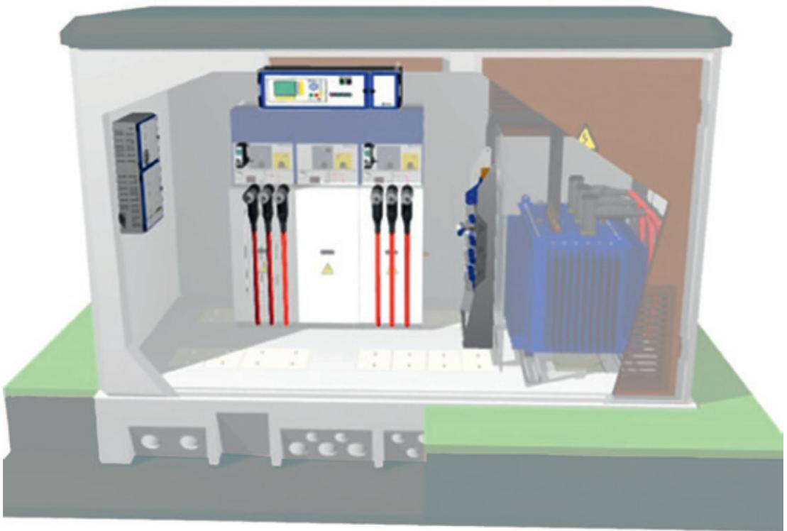
Fig. 53. Esquema de centro de transformación automatizado
