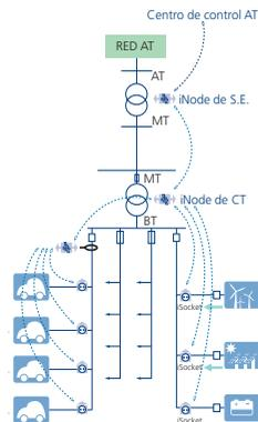
Fig. 62. Esquema simplificado de arquitectura de control. iNodes-iSockets (pág. 90)
