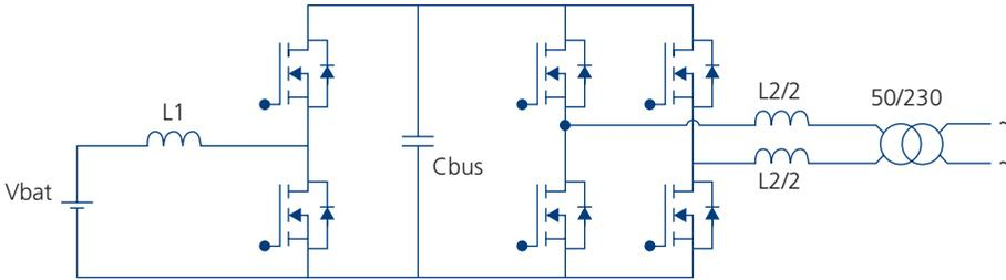
Fig. 79. Convertidor de potencia del SAD
