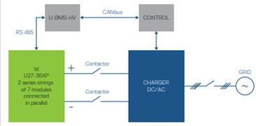
Fig. 33. Esquema de instalación de los equipos del sistema de almacenamiento (pág. 54)
