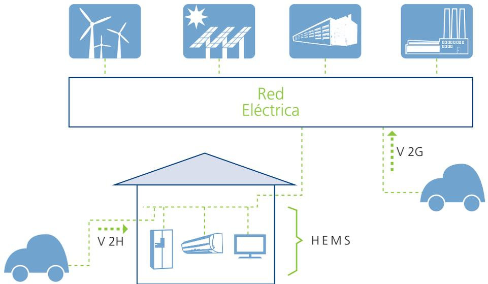
**Fig. 36.** Integración de vehículos eléctricos con capacidad de almacenamiento y descarga de energía (Fuente: <http://www.itrc.jp>)
