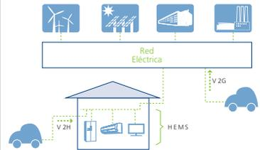
Fig. 36. Integración de vehículos eléctricos con capacidad de almacenamiento y descarga de energía (Fuente: <http://www.itrc.jp/>) (pág. 60)
