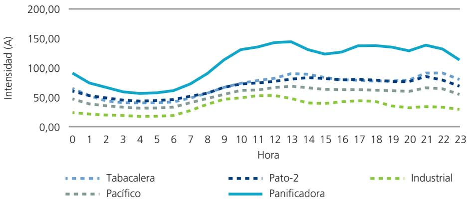
Fig. 6. Curva de carga media diaria de cada una de las líneas de MT (20 KV) de Smartcity Málaga en el mes de julio del año 2010
