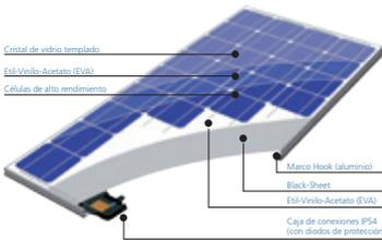
Fig. 31. Módulo fotovoltaico modelo A-95P de ATERSA (pág. 54)
