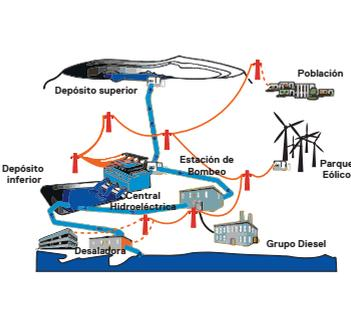
Fig. 102. Gráfico de elementos que conforman la central hidroeléctrica de El Hierro
