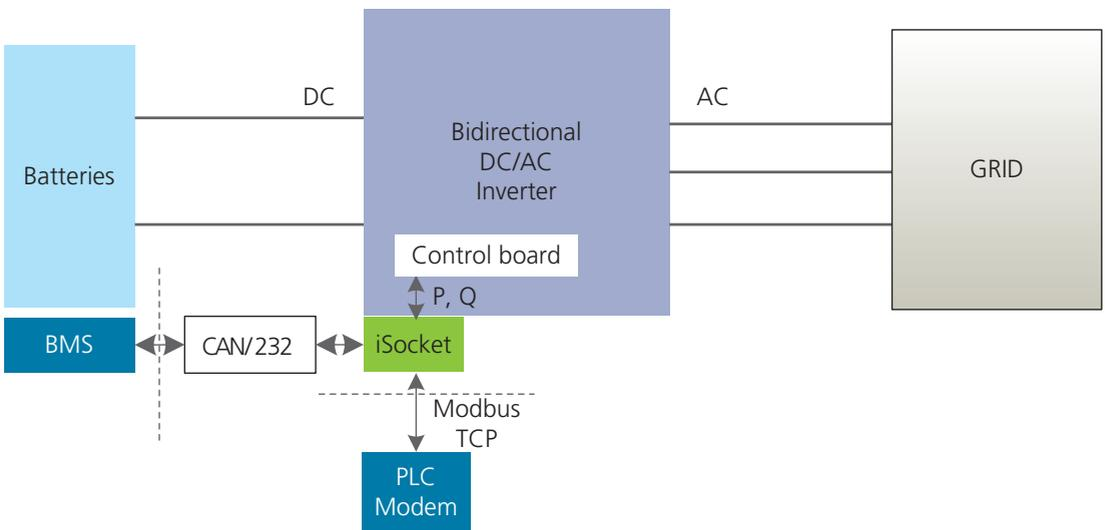
Fig. 89. Detalle de la estructura de los componentes de control y comunicaciones
