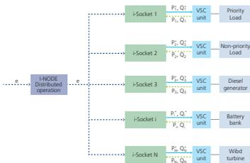
Fig. 73. Esquema de control en modo distribuido (pág. 101)
