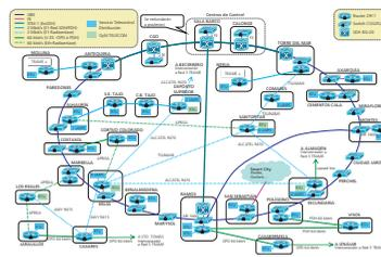
Fig. 41. Esquema físico de la red de fibra óptica desplegada (pág. 74)
