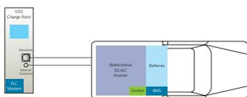
Fig. 88. Esquema de conexión del cargador con el punto de recarga (pág. 122)
