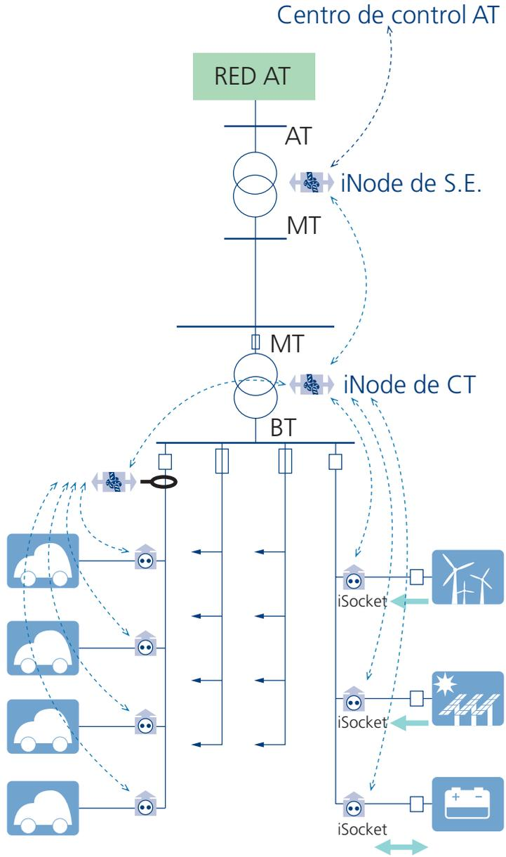
Fig. 62. Esquema simplificado de arquitectura de control. iNodes-iSockets
