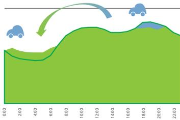
Fig. 37. Aplanamiento de la curva de demanda mediante vehículos eléctricos puntos de recarga V2G (Fuente: Red Eléctrica de España) (pág. 61)
