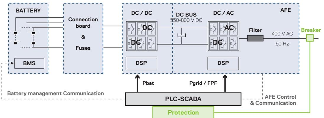
Fig. 23. Diagrama de bloques del sistema de almacenamiento
