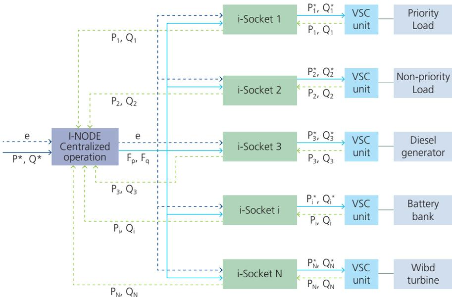
Fig. 71. Esquema de control en modo centralizado
