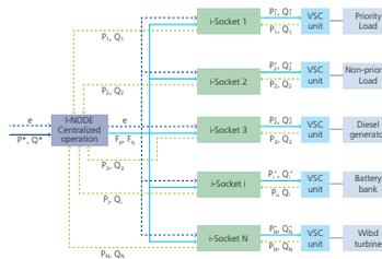
Fig. 71. Esquema de control en modo centralizado (pág. 104)
