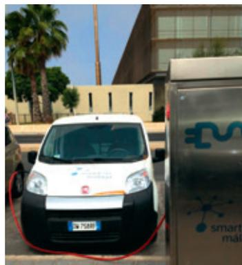
Fig. 90. Vehículo eléctrico adaptado y punto de recarga V2G desarrollados. Detalle del punto de recarga (pág. 124)
