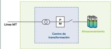
Fig. 24. CT con almacenamiento conectado a un nodo de MT de la red de distribución (pág. 48)
