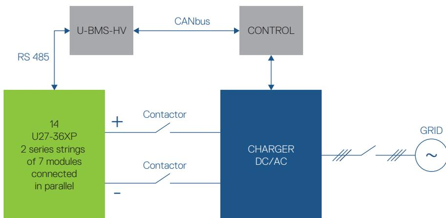
Fig. 33. Esquema de instalación de los equipos del sistema de almacenamiento
