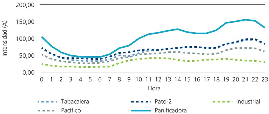
Fig. 5. Curva de carga media diaria de cada una de las líneas de MT (20 KV) de Smartcity Málaga en el mes de enero del año 2010
