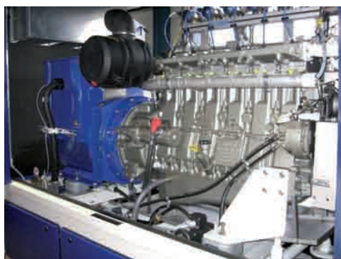
Foto 4. Generador (en azul) refrigerado por aire del equipo Senergino S5 (Altare).
