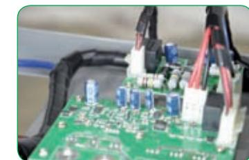
Controlador de carga solar integrado. Gestiona la carga de la batería desde los paneles de forma eficiente prolongando su vida útil. Integrated solar charge controller. Manages the battery charge from panels efficiently prolonging its life.
