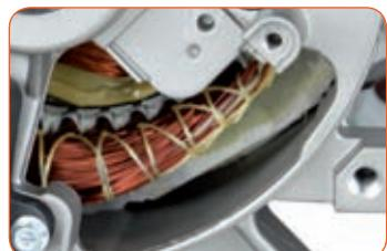
Alternador 100% bobinado en cobre.
