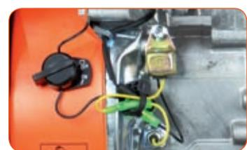
Equipado con desconexión por falta de aceite para prevenir daños por falta de lubricación.
