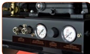
Dos salidas de aire con conector rápido, regulador de presión e indicadores de presión de tanque y de salida de aire. Two air supply with quick connector. Pressure regulator and gauge of tank pressure and air supply.
