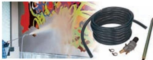
Gracias al efecto venturi, la arena u otros abrasivos son aspirados por el flujo de agua a alta presión, dando como resultado la proyección a alta presión de arena húmeda, capaz de desgastar por abrasión cualquier material. Muy útil para decapar metales, limpieza de roca o piedra, desprender grafitis, etc.
