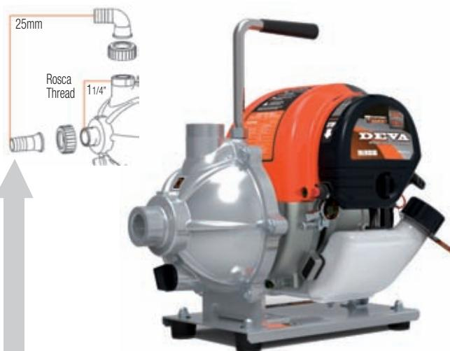
\*Para conectar camlock de 1" directamente en esta bomba requiere de una reducción ya que la rosca de la bomba es de 1.1/4".
