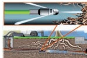
Ideal para la limpieza de alcantarillado, canales, desagües, grandes tuberías etc. La manguera de alta presión con trenzado de acero ofrece una alta resistencia y durabilidad. Gracias al pedal de control podemos abrir o cerrar la presión de agua al mismo tiempo que usamos ambas manos para introducir la manguera durante el desatascos. Disponibles boquillas de desatascos estándar y rotativa.
