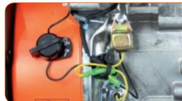
Equipado con desconexión por falta de aceite para prevenir daños por falta de lubricación.
