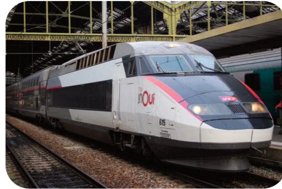
TGV Réseau Duplex (France)
