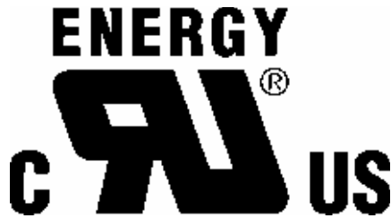
Figura 2. Logotipo indicativo de los motores de alto rendimiento que cumplen con EEAct y EPAAct verificados por UL ( Underwriters Laboratories Inc. ).
