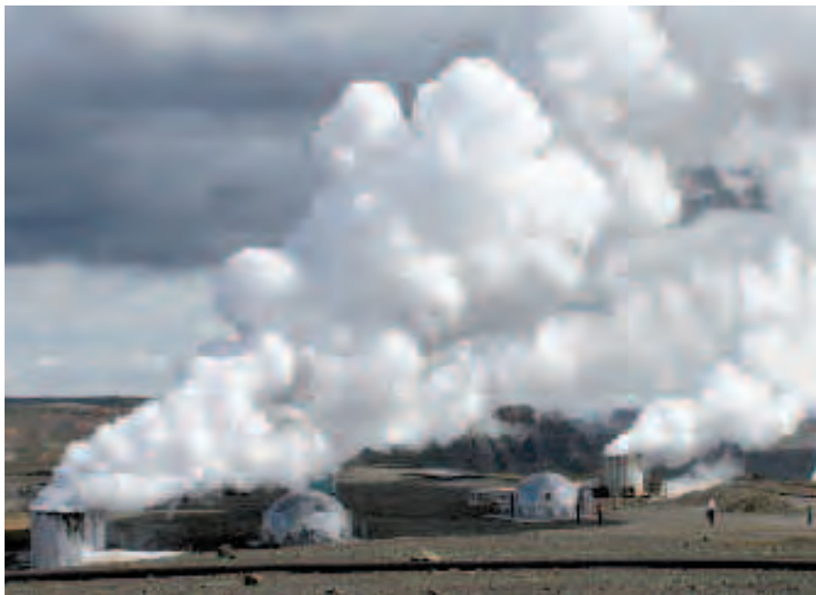
Prueba de producción de sondeos geotérmicos cerca de Hellisheidi (Islandia)
